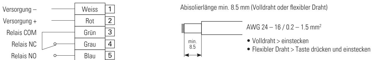
Abisolierlänge min. 8.5 mm (Volldraht oder flexibler Draht)
