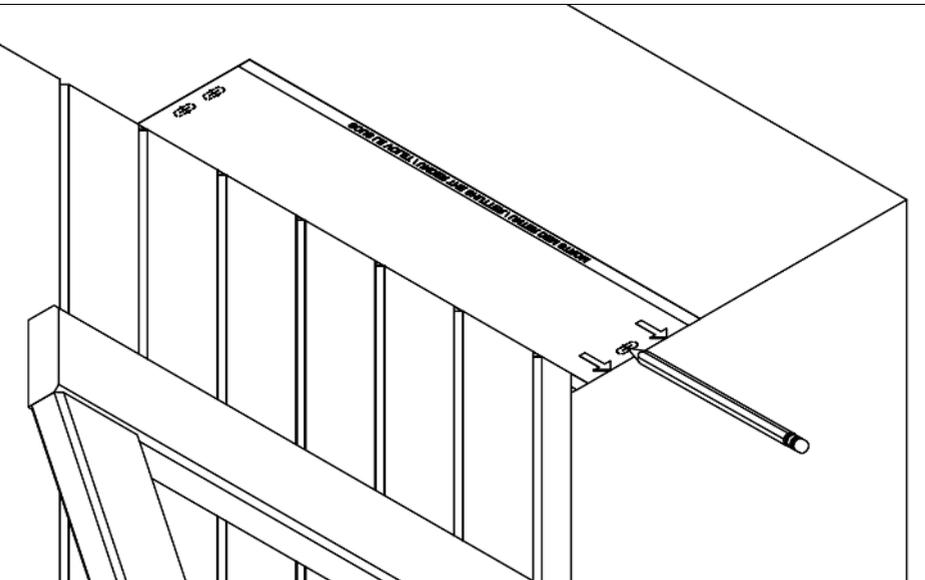
Löcher mit  $\varnothing 6$  bohren und Dübel einführen.
