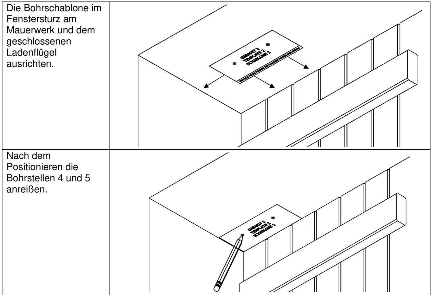
Die Schablone 1 im Fenstersturz am Mauerwerk und dem geschlossenen Ladenflügel ausrichten.
