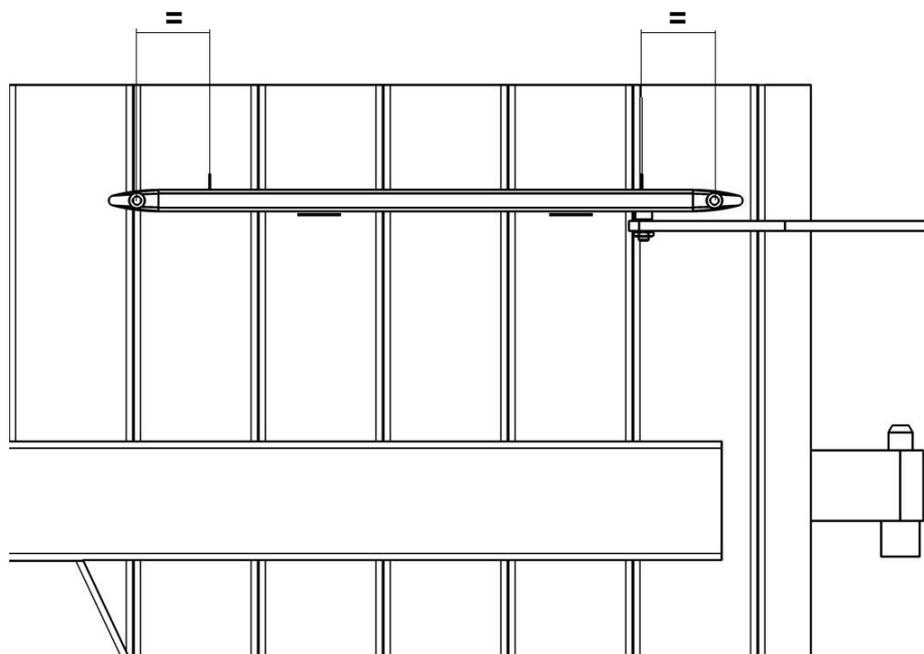
4.6 Die Schiene nach den zwei C Markierungen in 26 mm Abstand der Abdeckung ausrichten, waagrecht ausrichten und die Schrauben anziehen.
