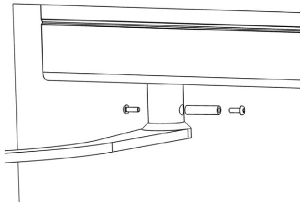
Hinweis: Der Sicherungsbolzen bricht bei übermässiger Krafteinwirkung auf die Klappläden (z.B. bei starkem Sturm), um Schäden am Motor zu verhindern.
