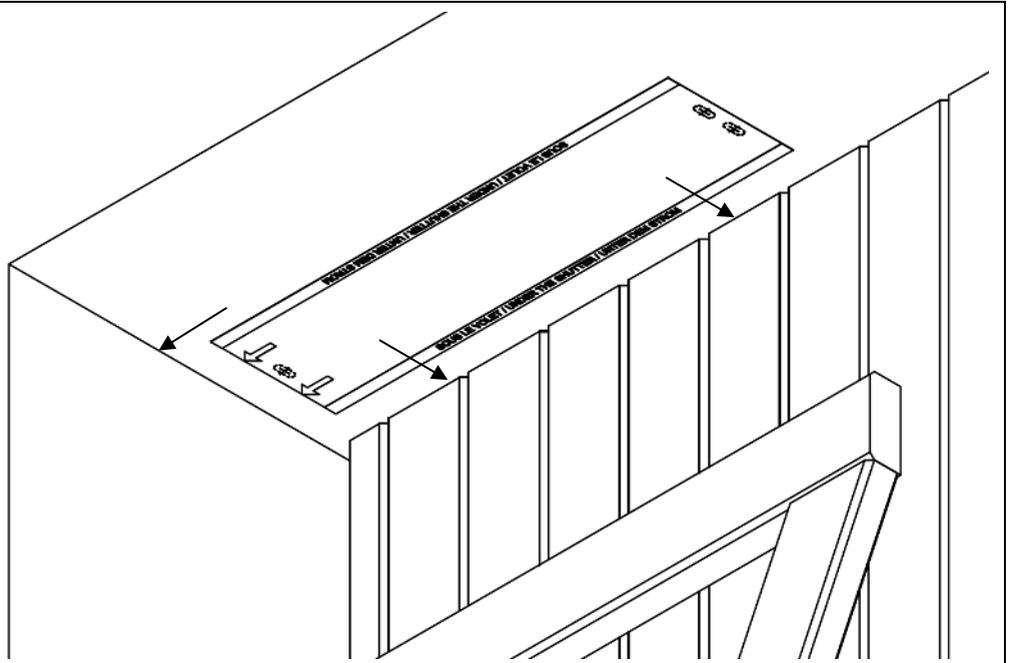
Nach dem Positionieren die Bohrstellen 1, 2 und 3 anreißen.
