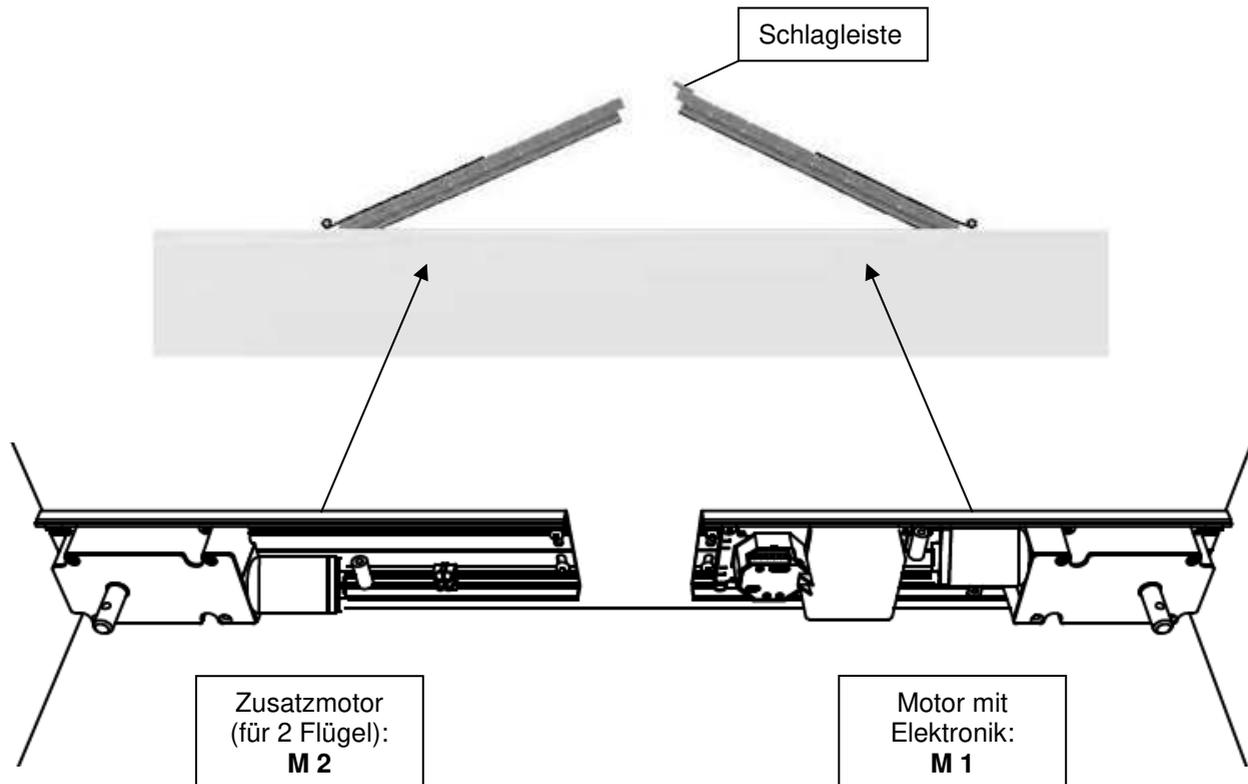
Hinweis: Wenn der überlappende Flügel auf der linken Seite ist, muss die Verkabelung getauscht werden, damit die Motoren die Flügel in der richtigen Reihenfolge drehen. Siehe S.13
