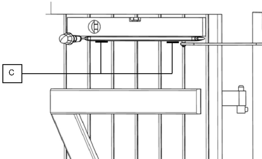
4.7 Prüfen, ob sich der Fensterladen einwandfrei drehen lässt. Der Fensterladen muss sich mühelos öffnen und schließen lassen. Anschließend den Schwenkarm mit dem Sicherungsbolzen am Motor fixieren.
