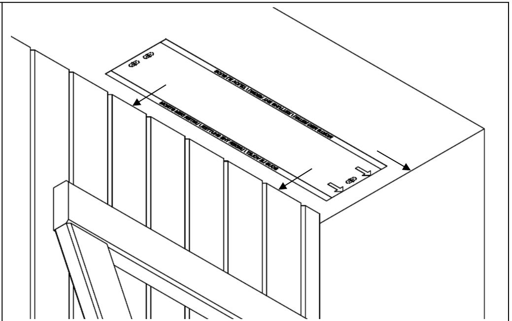
Nach dem Positionieren die Bohrstellen 1, 2 und 3 anreißen.
