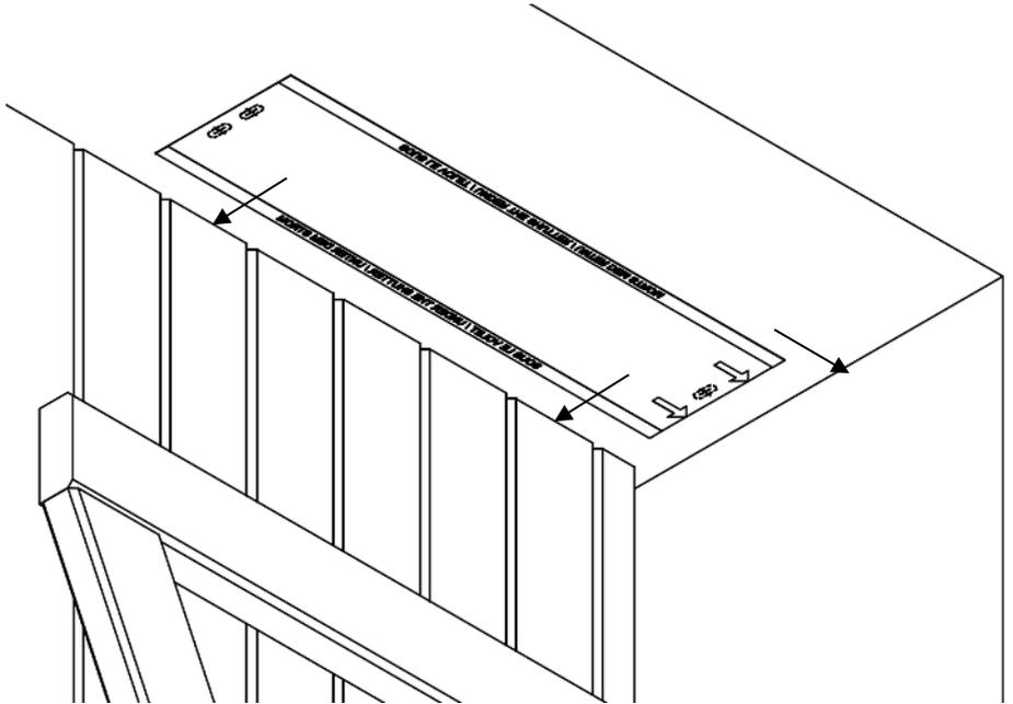
Nach dem Positionieren die Bohrstellen 1, 2 und 3 anreißen.
