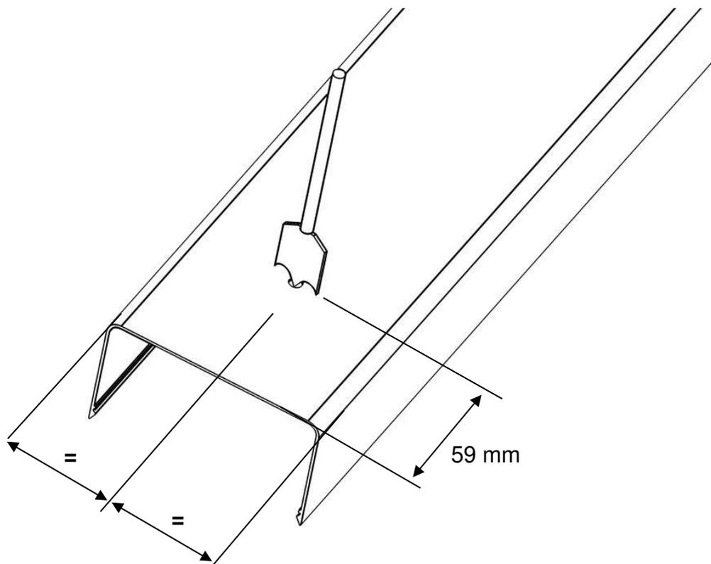
Nach Überprüfung des ordnungsgemäßen Betriebs des Produktes die Abdeckblende anbringen. Die Abdeckblende muss mittig zwischen den 2 Motoren angebracht werden.
